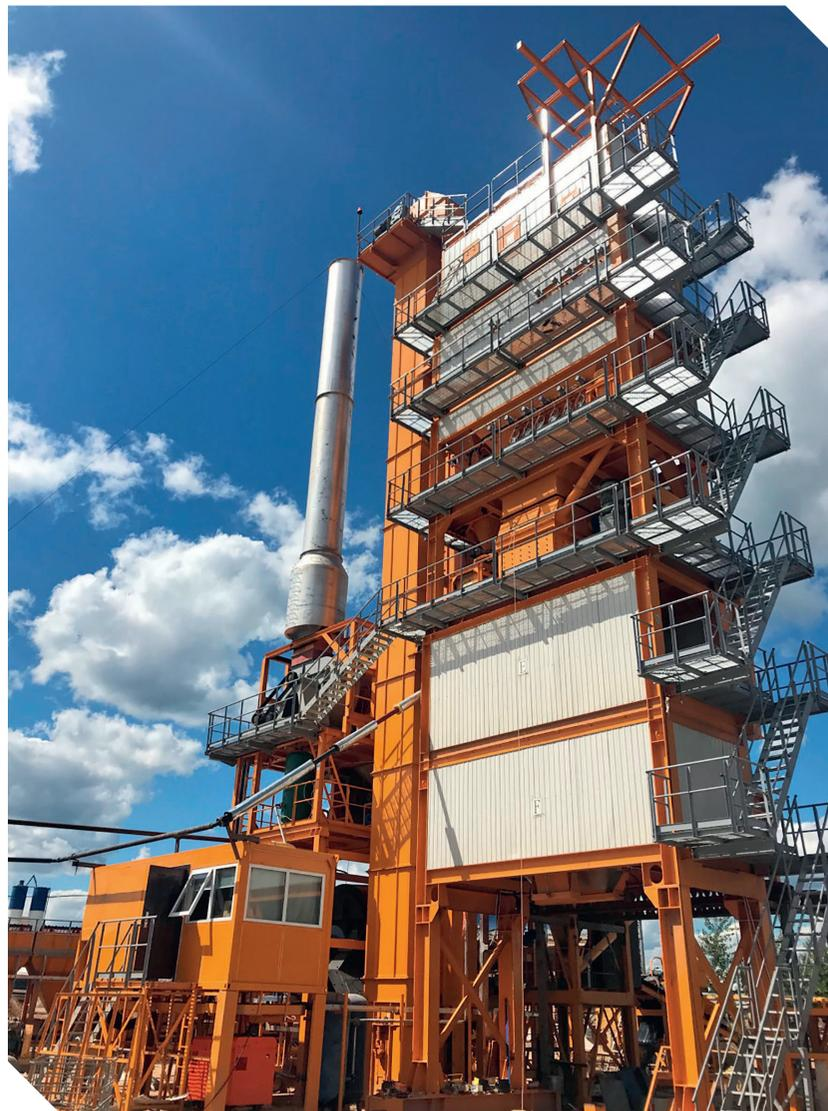
Поставка и запуск в эксплуатацию стационарного асфальтобетонного завода АММА АВР240. г. Москва
