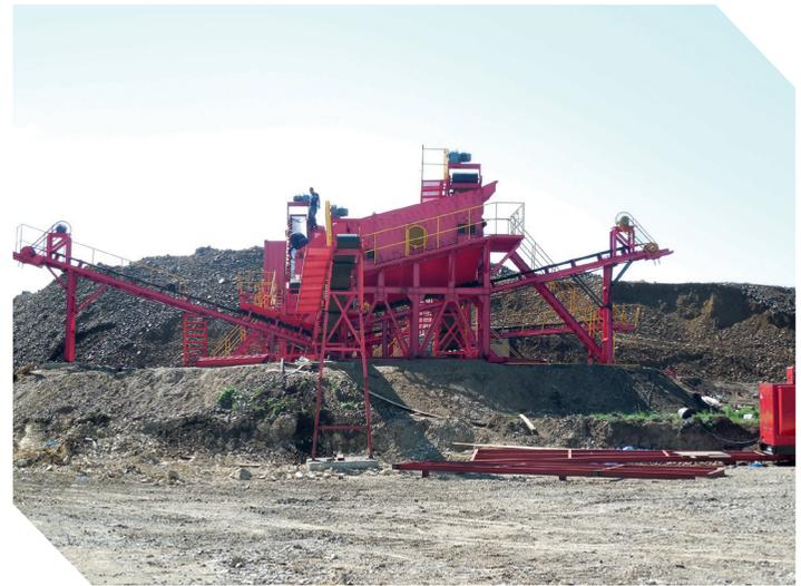
4. Замена плосковзвонной цепи на наклонном элеваторе асфальтобетонного завода SPECO TSAP-2500FFW на цепь с горизонтальным креплением ковшей. Казахстан, 2014 год.
