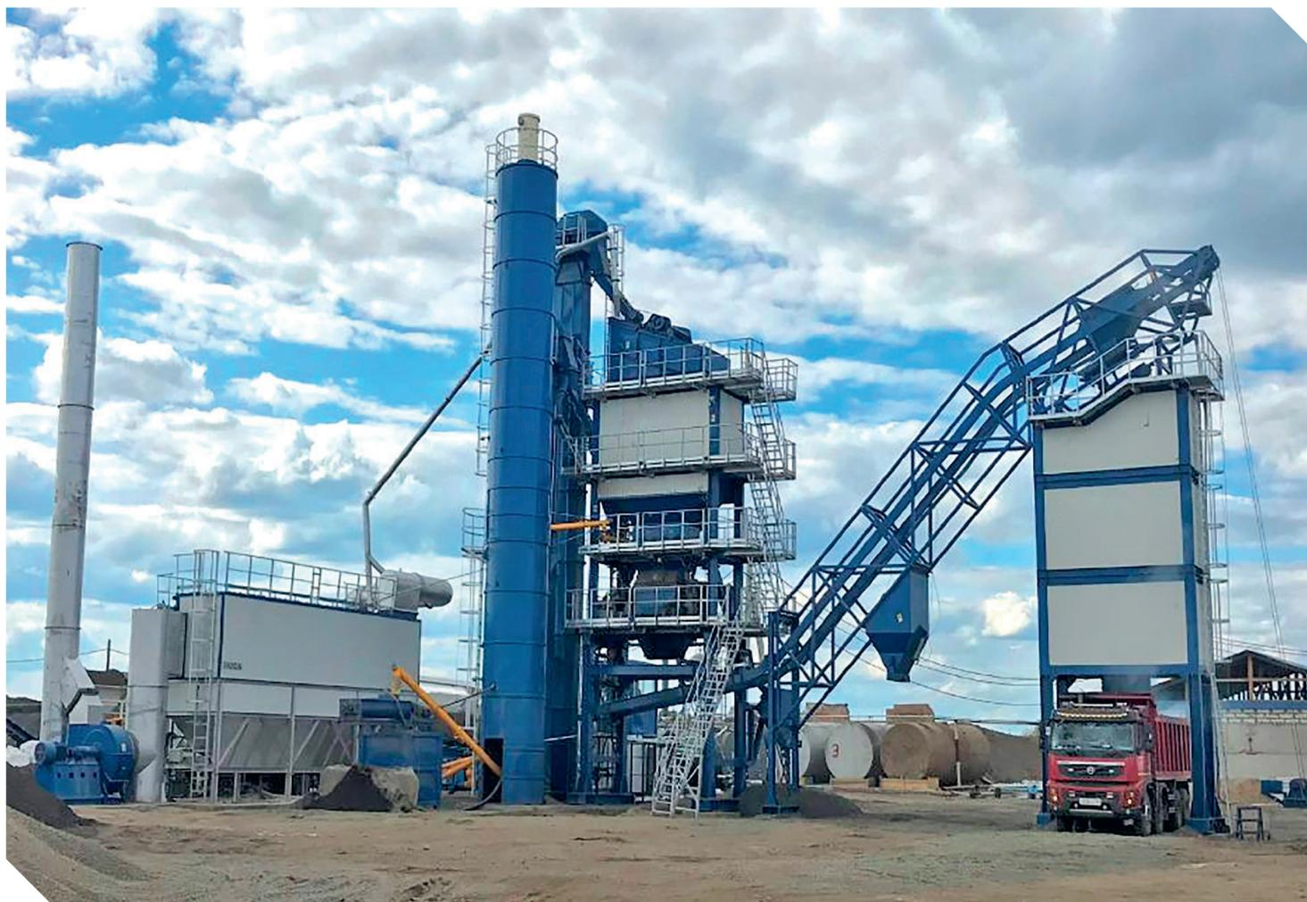
Поставка и запуск в эксплуатацию стационарного асфальтобетонного завода АММА АВР80 Киргизия, г. Ош
